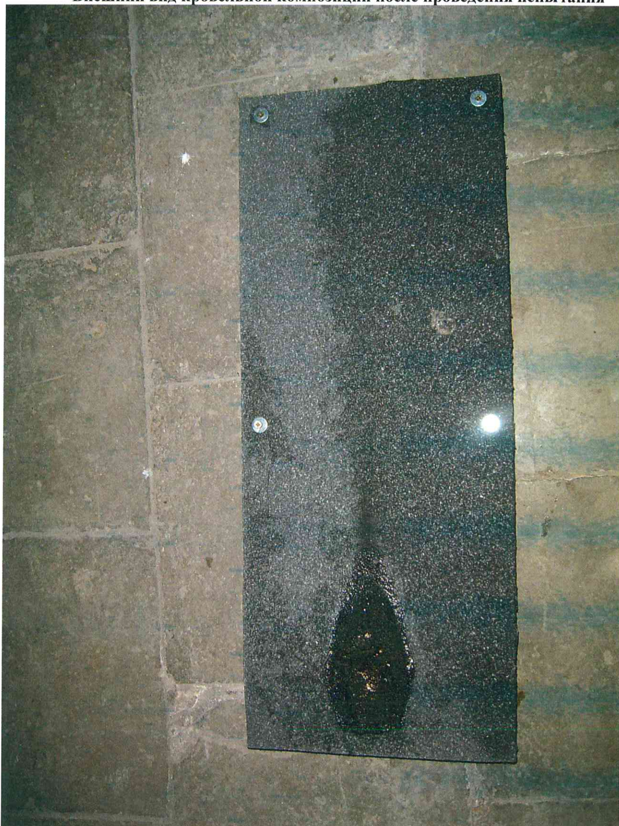
Внешний вид кровельной композиции после проведения испытания
