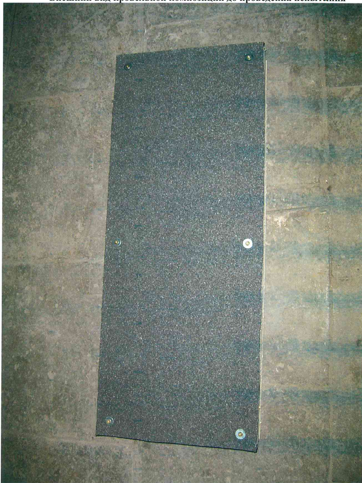
Внешний вид кровельной композиции до проведения испытания
